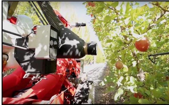
*Figura 26: Recolector de manzanas de Abundant Robotics
