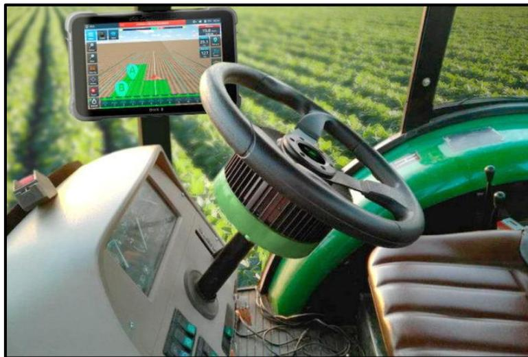
**Figura 17: Autoguiado montado en la cabina de un tractor**
