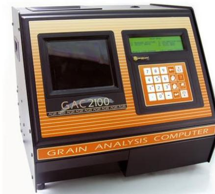
**Figura 3. 1 Equipo GAC210, determinación de peso volumétrico y contenido de humedad**
