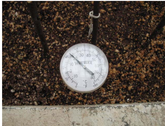
Figura 3. Termómetro de suelo para monitorear las temperaturas
