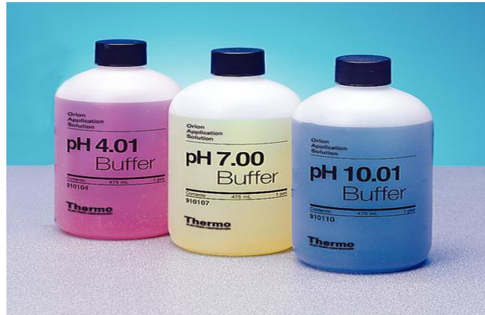
Figura 7.- Soluciones buffer, se utiliza una con solución ácida con pH de 4 y otra neutra con pH de 7.
