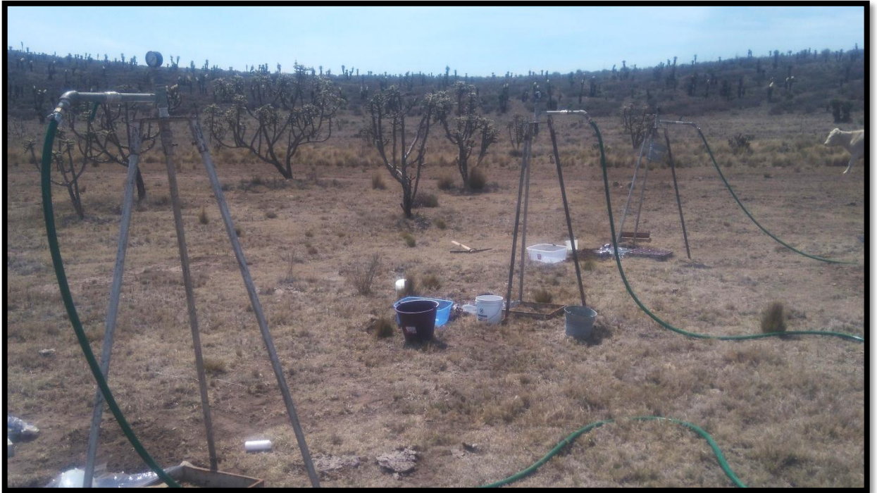
Figura 3.6.- Simulador portátil y de boquilla simple utilizado en el área de estudio.
