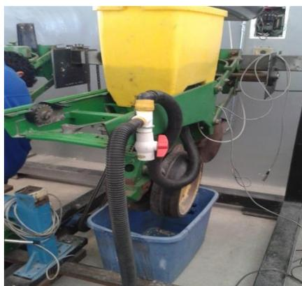
**Figura 3.5** Banco de pruebas del sistema dosificador neumático.
