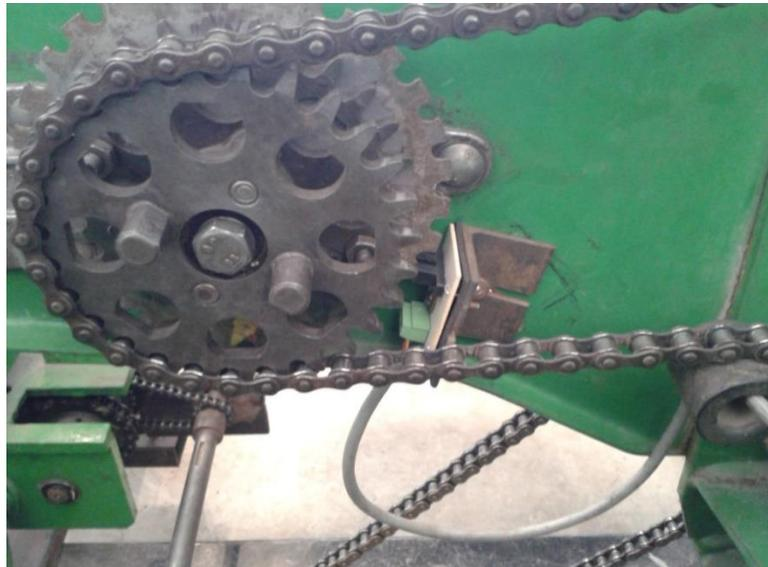
**Figura 3.12** Disco de aleación tipo comercial con 30 perforaciones.
