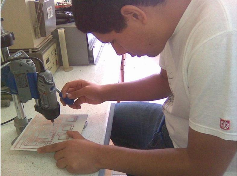
**Figura B5** Perforado de la tarjeta electrónica.
