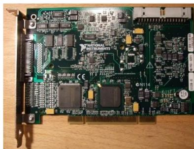
Figura 3.9 Tarjeta de adquisición de datos PCI-NI-6221.
