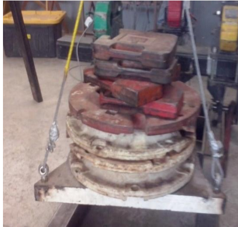
Figura 3.6. Acomodo de contrapesos en la canastilla del banco de calibración.
