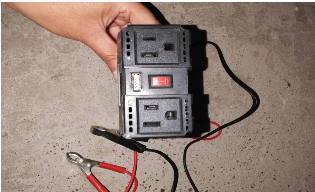
Figura 9. Fotografía de inversor toma frontal.
