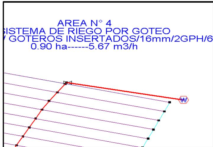
**Figura 3.8.** Dibujo de la línea principal, fuente de agua y la bomba en el bloque de riego de IRRICAD.
