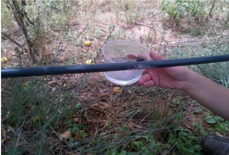
**Figura 3.6.**Medición del volumen de agua suministrada por los emisores.
