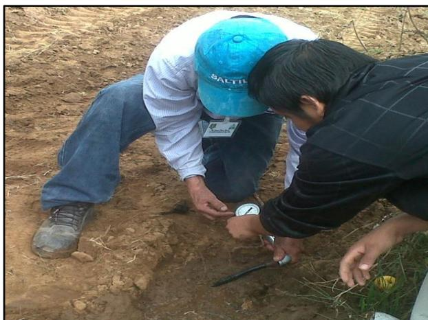
**Figura 3.7.** Medición de la presión al final de la línea regante.
