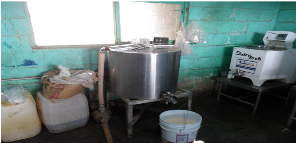
Figura 5: Pasteurizador de calostro
