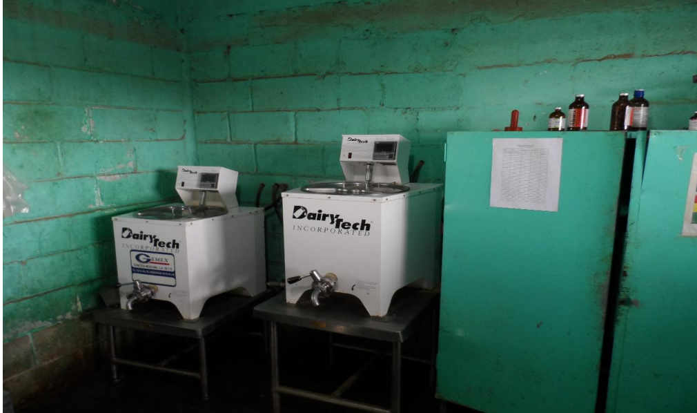
Figura 4: Pasteurizador de calostro
