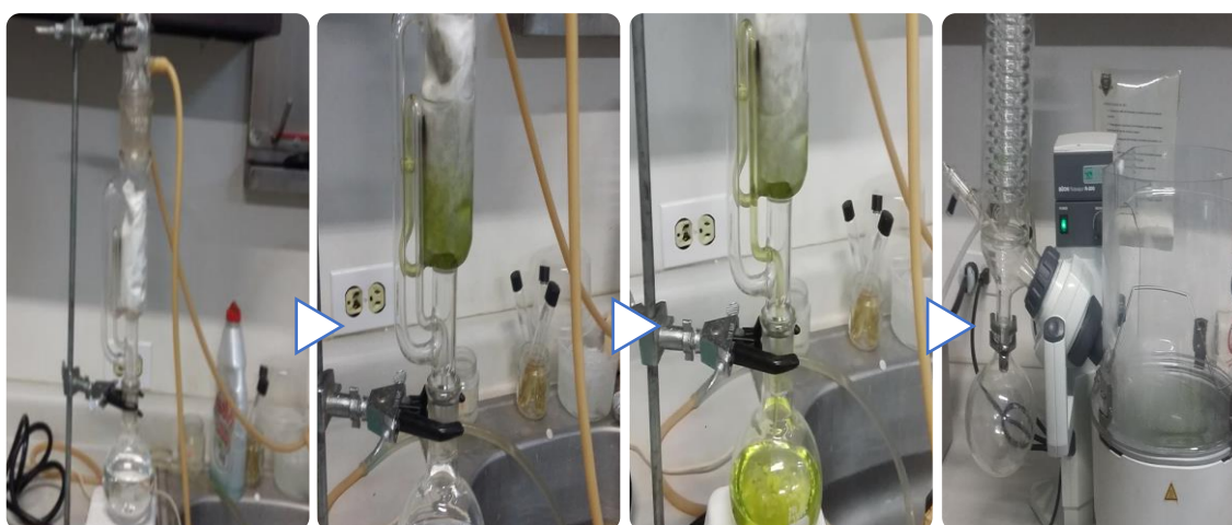
Figura 1. Extracción por soxhlet y concentración en el rotavapor.
