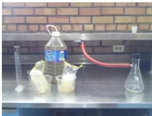
Fig. 3.12. Determinación de SST.
