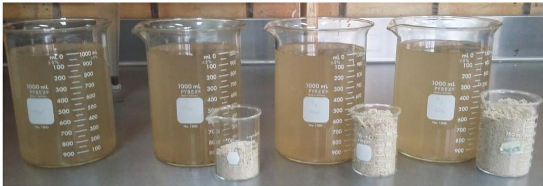
Figura 3.8. Muestra de agua residual con diferentes porciones de *Moringa*.
