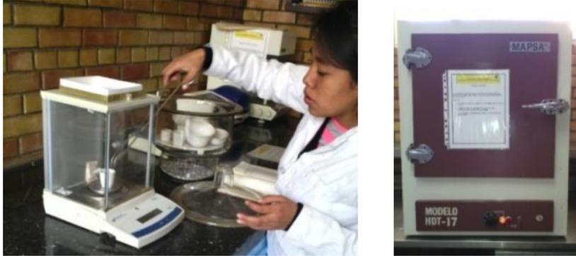
Fig. 3.13. Determinación de SSV.
