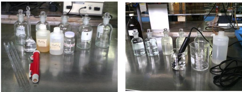
Fig. 3.18. Determinación de la Demanda Bioquímica de Oxígeno (DBO<sub>5</sub>).
