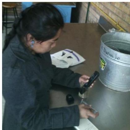
Figura 3.10. Determinación de pH.
