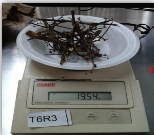
Figura 19. Balanza semi-analítica Marca OHAUS Modelo 293A, utilizada para determinar el peso seco de hoja, tallo, flor y fruto de las muestras de plantas de chile jalapeño ( Capsicum annuum L.) Var. Mitla.
