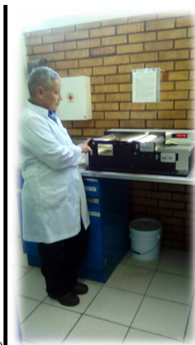
Figura 17. Muestra colectada (a), y Medidor de área (b), Marca LI-COR utilizado determinar el área foliar de de las plantas de chile jalapeño ( Capiscum annum L.) var. Mitla.
