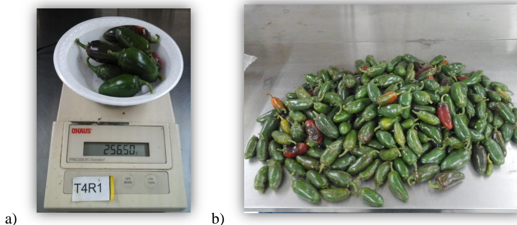
Figura 20. Balanza semianalítica Marca OHAUS Modelo 293A (a), utilizada para obtener el peso fresco del fruto y muestreo de frutos para determinar rendimiento (b).
