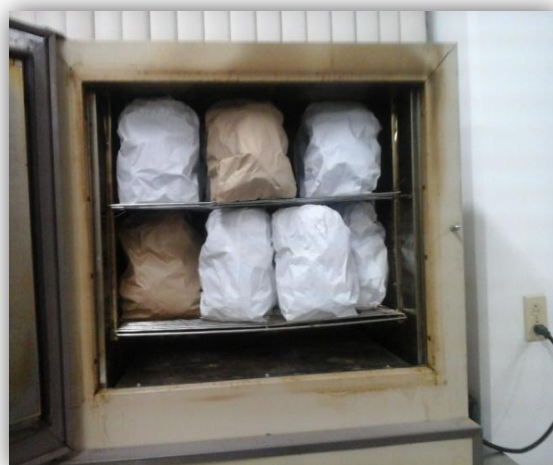
Figura 18. Estufa de secado Marca FELISA Modelo 293A utilizada a 70°C, y muestra seca obtenida de hojas, tallos, flores y frutos.
