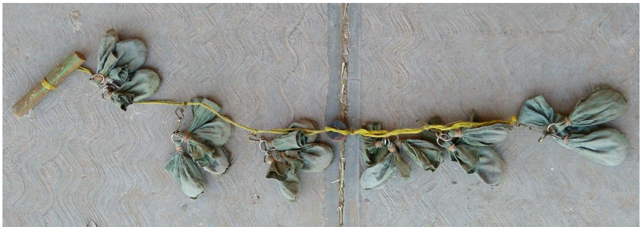
Figura 6. Ancla con contrapeso con las muestras ya colocadas
