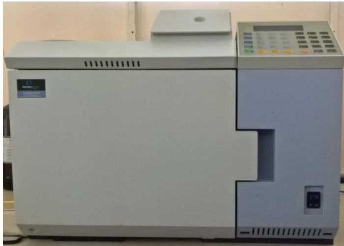
Figura 2 Cromatógrafo de gases, marca Perkin Elmer Autosistem XL, en donde se analizaron las muestras
