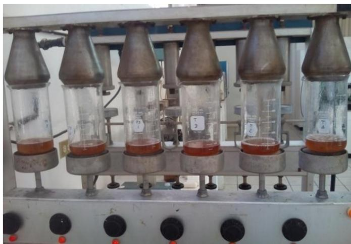
**Figura 5. Aparato de reflujo en determinación de Fibra Cruda**
