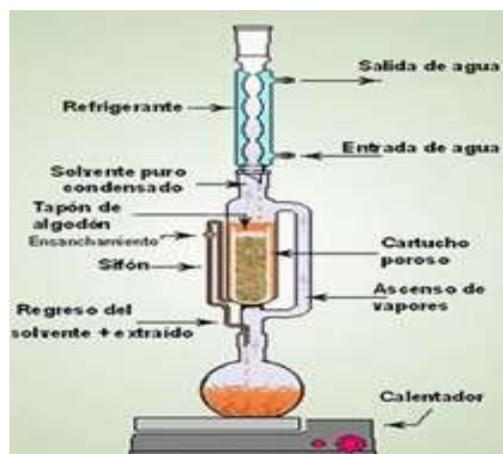
**Figura 7.** Diagrama esquemático de equipos para extracción líquido- líquido en forma continua, CIATEJ, 2007.
