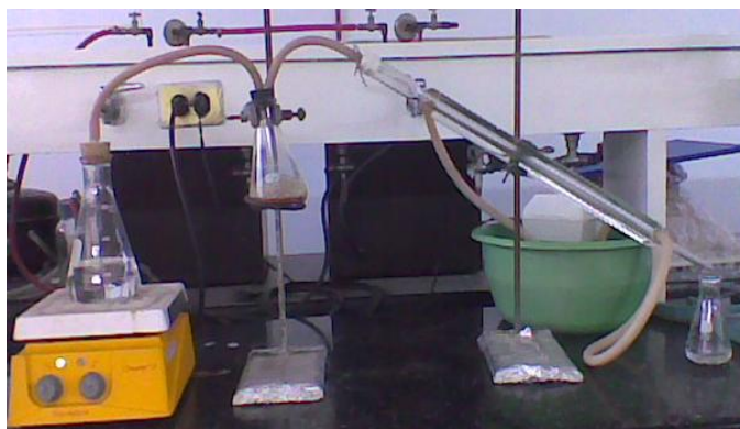
Figura 5. Extracción de aceite por arrastre de vapor.
