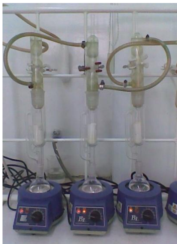
Figura 4. Extracción de aceite por método Soxleth.
