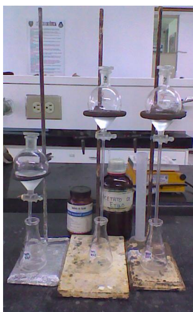
Figura 6. Separación de las fases con acetato de etilo.
