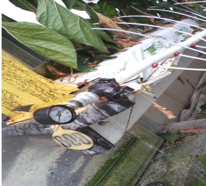
**Figura 3.7.** Medición de la presión al final de la línea regante.
