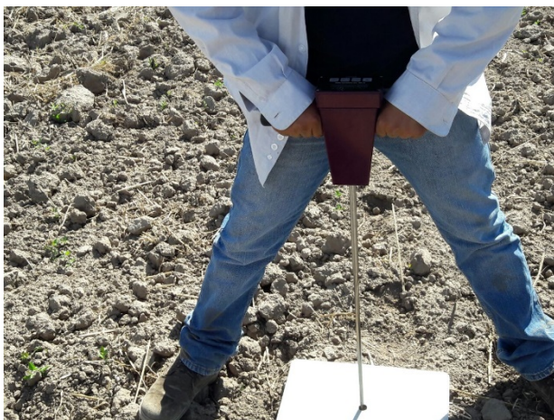
Figura 8: FIELDSCOUT SC 900 para medir resistencia a la penetración
