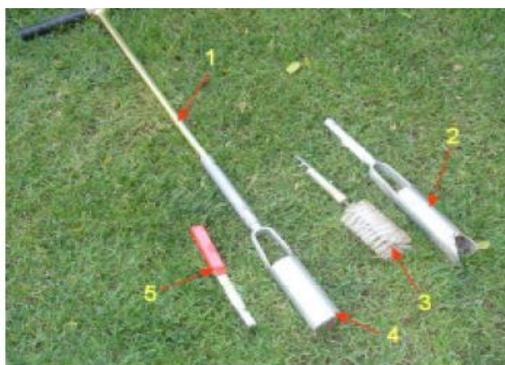
Figura 4. Barrenas (instrumentos para perforar).
