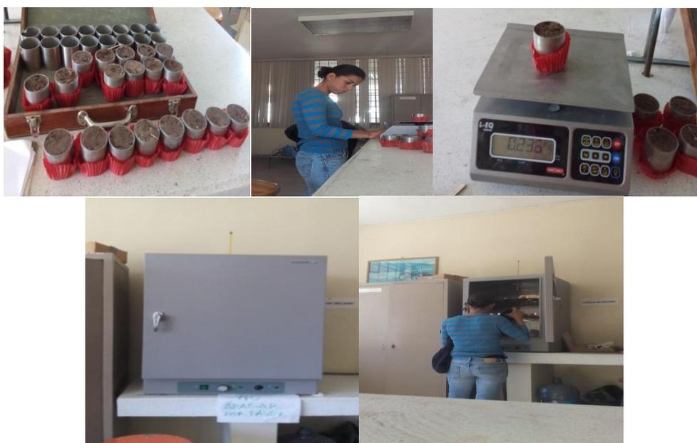
Figura 15. Pesado y secado de las muestras en la estufa.
