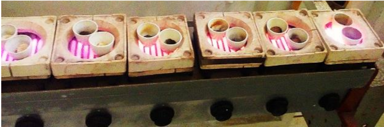
Figura 20. Incineración de las muestras en una parrilla (LABCONCO).
