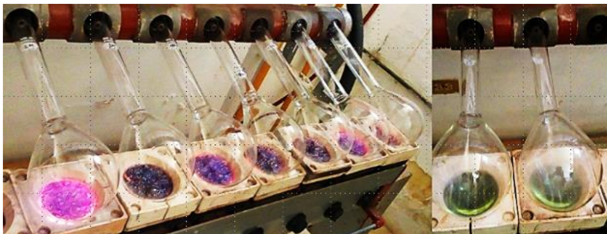
Figura 22. Cambio de color de las muestras durante la digestión en parrillas de aparato Kjeldhal.
