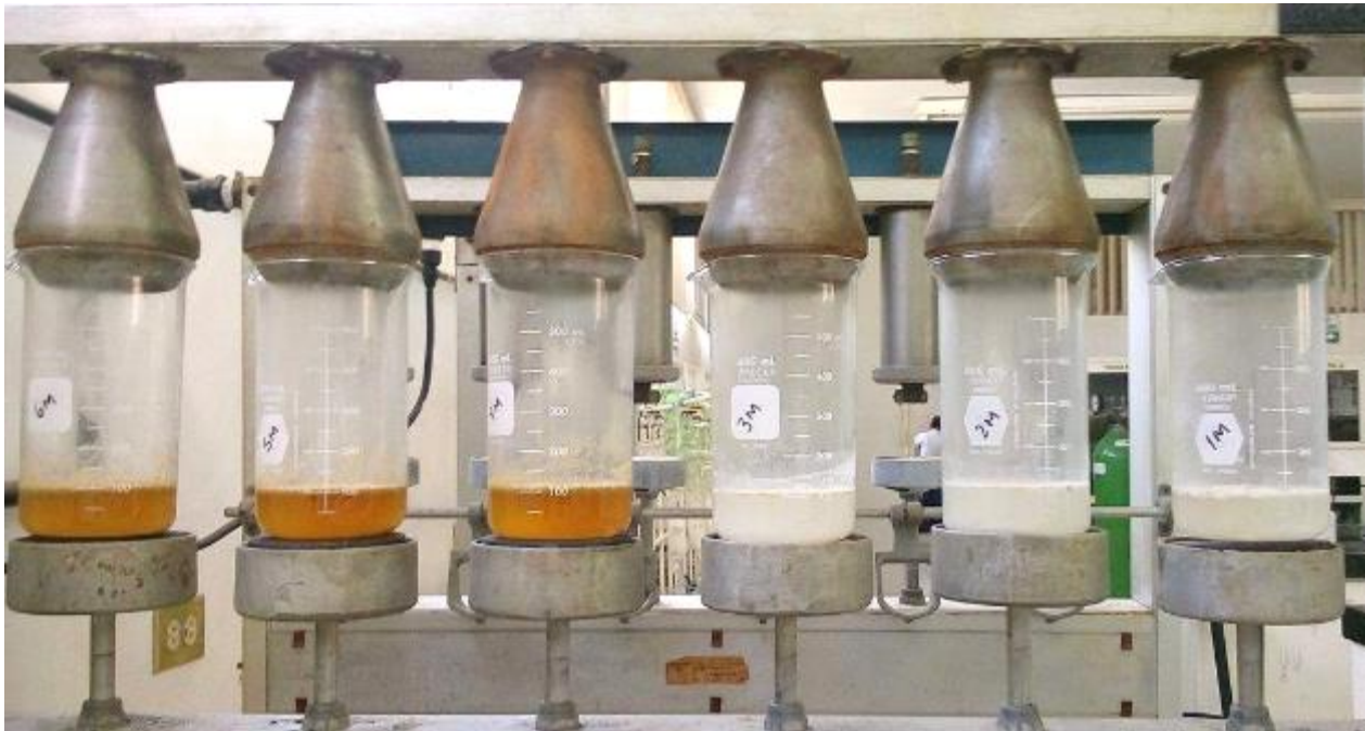
Figura 25. Digestor Labconco con vasos de Berzelius instalados.
