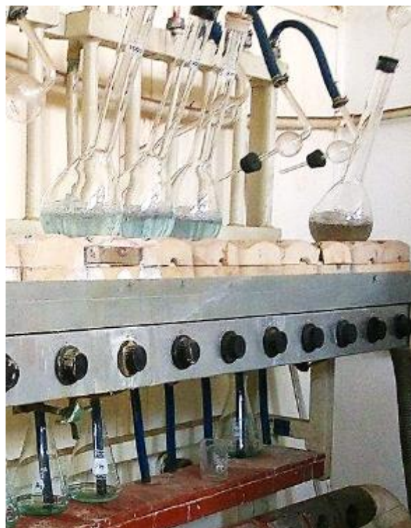
Figura 23. Parte destiladora del aparato Kjeldhal.
