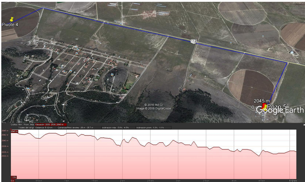
FIGURA 28. Líneas de Suministro Línea Pozo 5 – Pivote 4. 10" PVC
