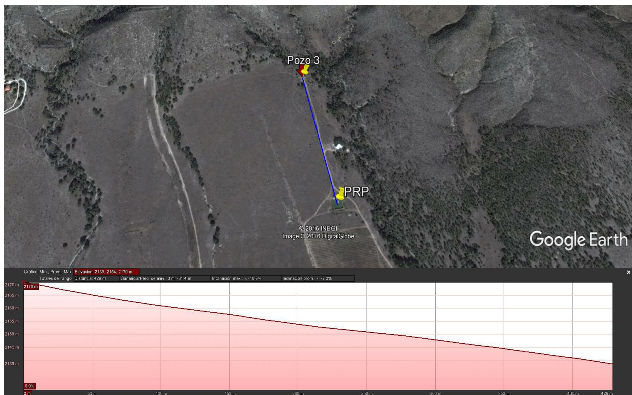
FIGURA 16. Líneas de Suministro Pozo 3 - PRP. 6" PVC
