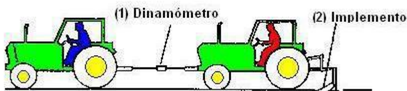
Figura 1.1: Fuerza de arrastre de un implemento acoplado al tractor
