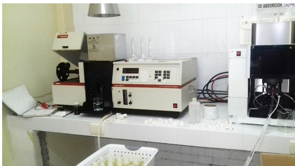
Figura 2.4. Determinación de potasio y magnesio por absorción atómica.
