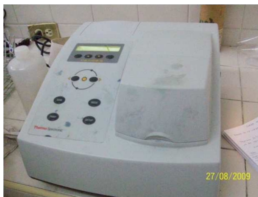
Figura 3 Espectrofotómetro, utilizado para la determinación de absorbancia, conocido así como un haz de luz que pasa a través de las muestras de miel dando una lectura de cantidad de azúcares disueltas en las mieles analizadas.
