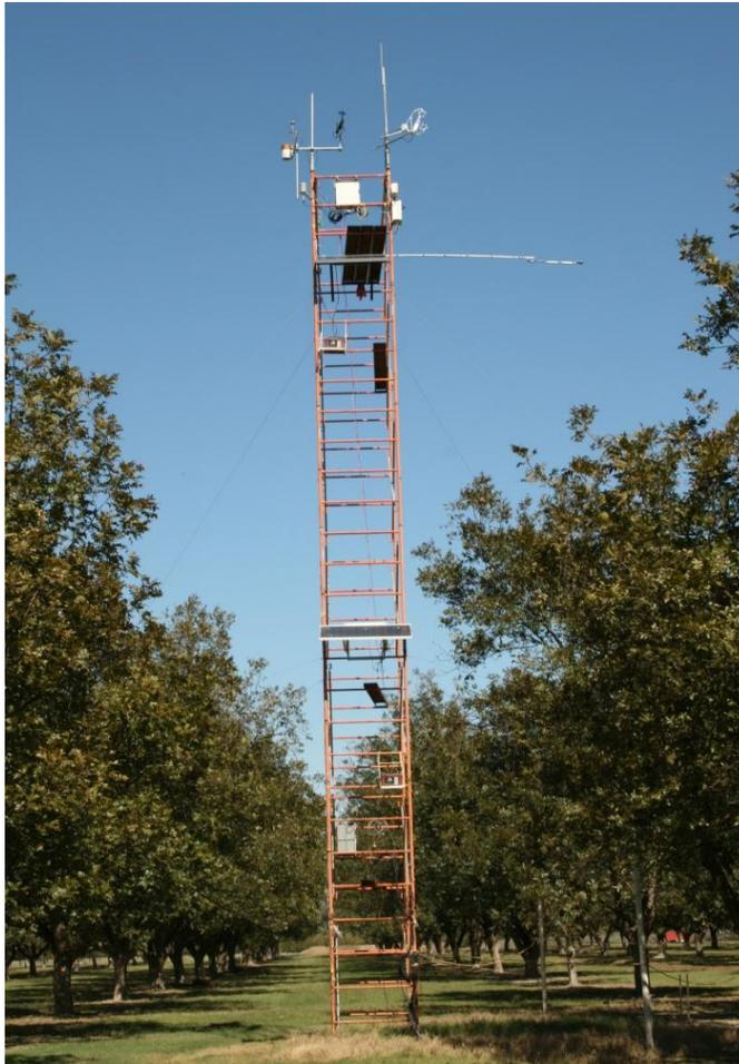
**Figura 1.** Sistema de covarianza de remolinos sobre el dosel de un cultivo de nogal pecanero para medir el flujo de calor, vapor de agua y CO<sub>2</sub>.
