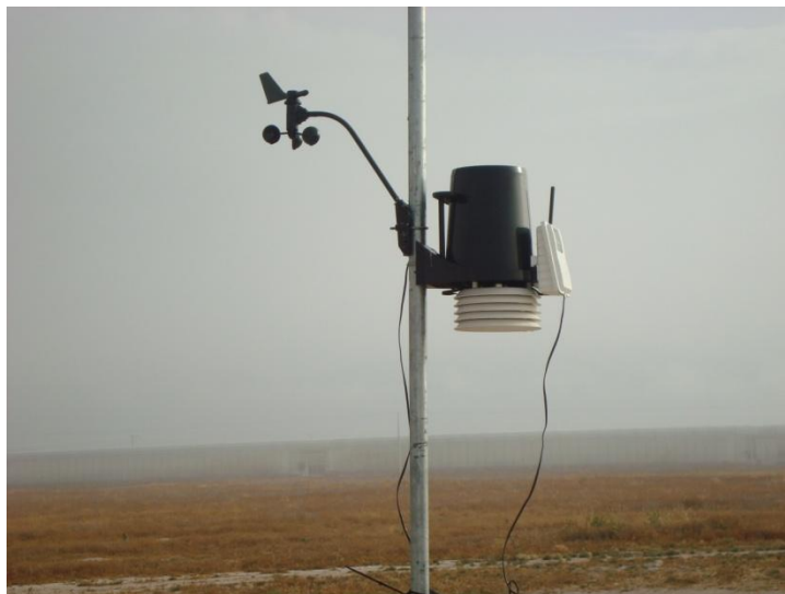
Figura 3.4. Estación meteorological Davis® Vantage Pro 2, instalada a unos 100 m del invernadero.
