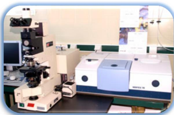
Figura 16. Foto del espectrofotómetro de rayos infrarrojos.
