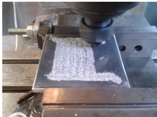
Figura 7.11 Maquinado de placa inicial.
