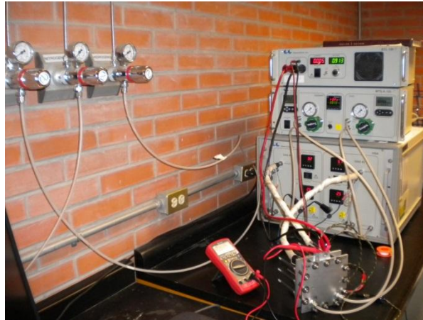
Figura 8.4 Preparación de la estación FTC 2000.
