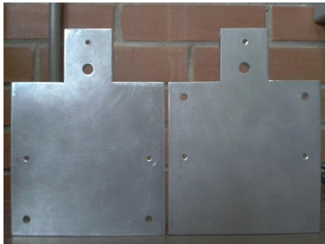
Figura 7.41 Aspecto final del electrodo.
