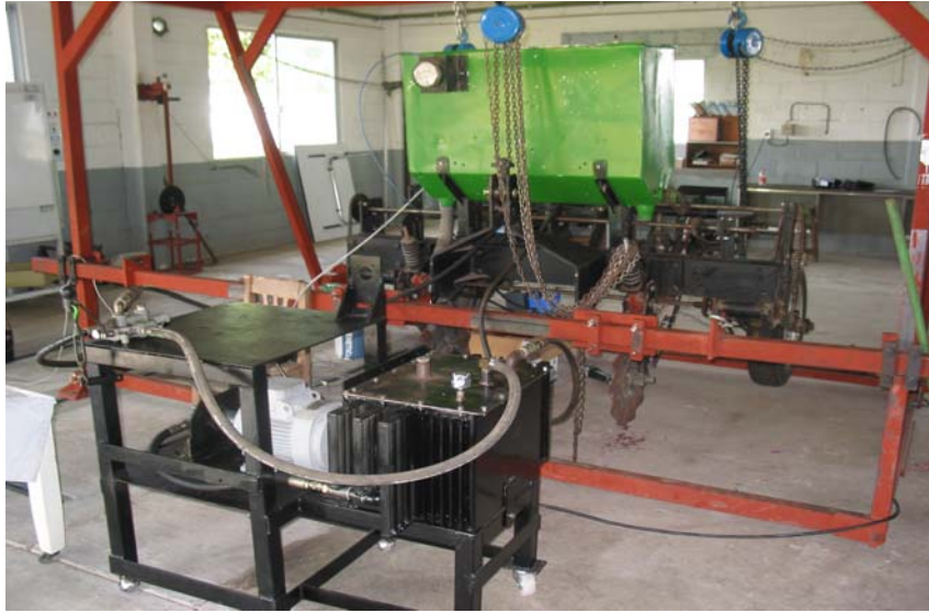
Figura 3.11. Banco simulador de potencia suministrada por el tractor.
