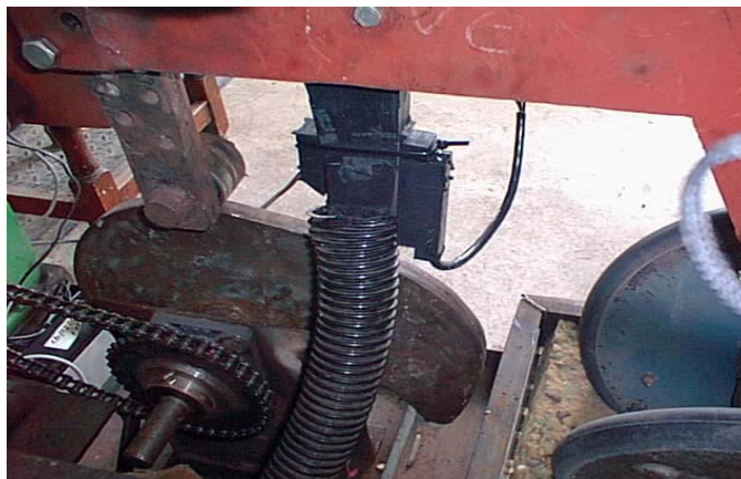
Figura 3.13. Sensor de caída de semilla A9321 John Deere
