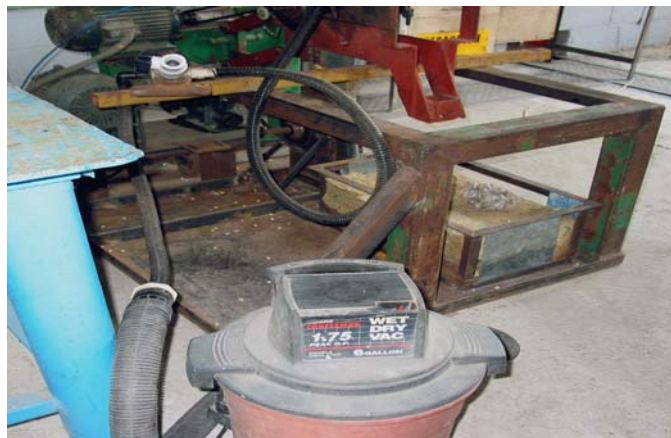
Figura 3.12. Sistema de Aspiración utilizado en las pruebas con impacto
