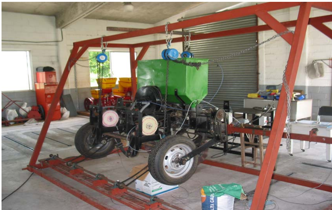
Figura 3.6. Banco de pruebas de sistema de dosificación de semilla sin impacto
