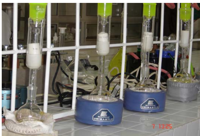
Figura 3. Extracción de aceite por el método Soxhlet
