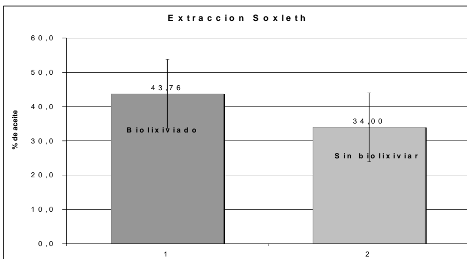
Figura 17. Porcentajes de extracción por el método Soxhlet de aceite obtenido del material biolixiviado y sin biolixiviar.
