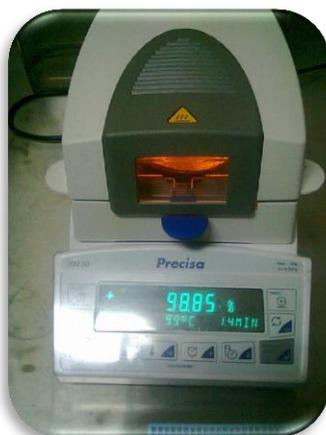
Figura 8. Termobalanza (Precisa XM 50), empleada para determinación de la humedad
