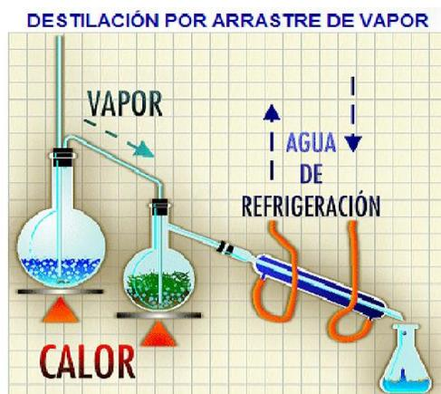
Fig. 2. Destilación por arrastre de vapor.
