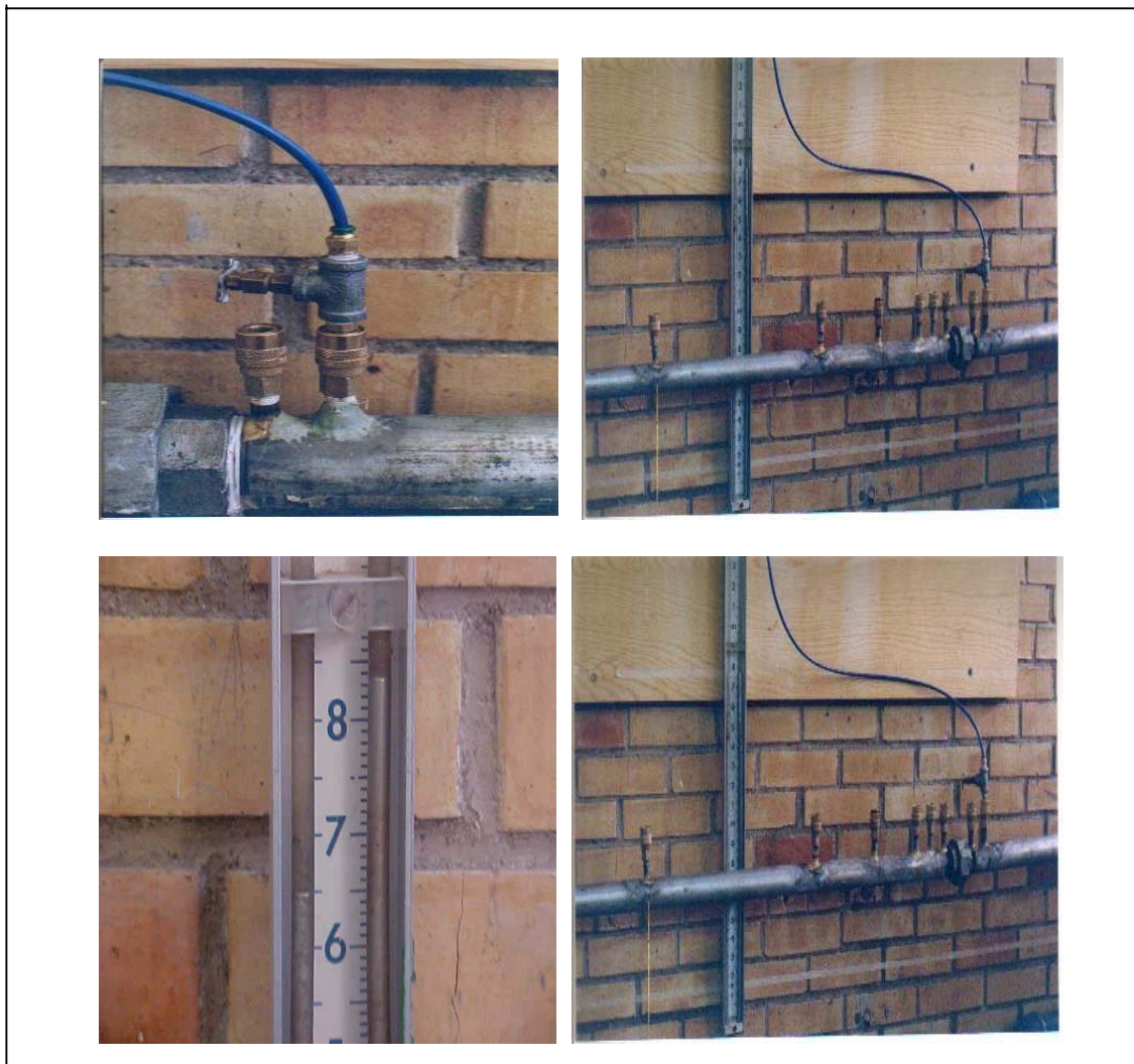
Figura 3. 4. Conectores rápidos, manguera y manómetro de mercurio, utilizados en la medición de las lecturas piezométricas.
