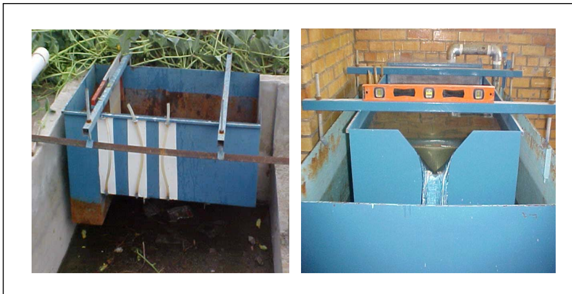
Figura 3.8. Vertedor triangular con tanque amortiguador, 3 piezómetros auxiliares y bastidores para su nivelación.
