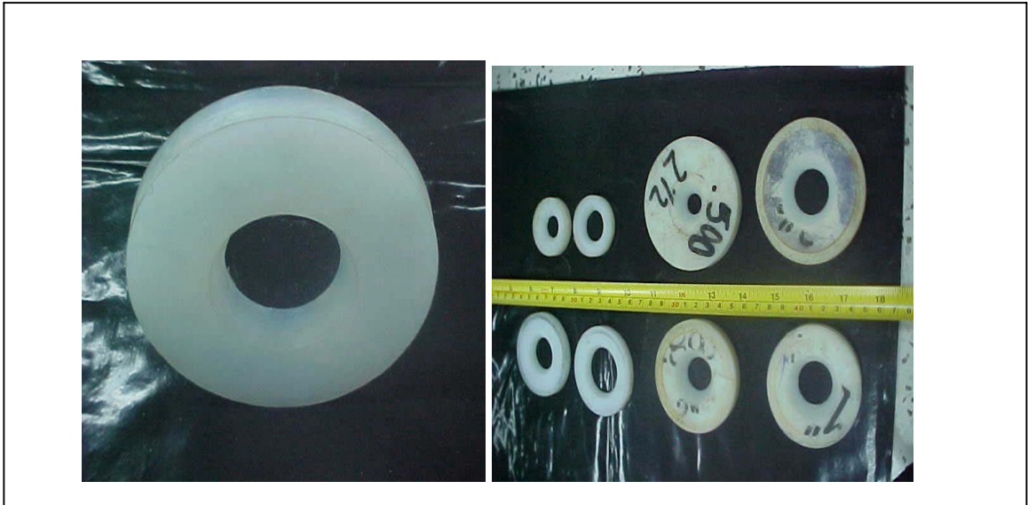
Figura 3.1. Diafragmas de polietileno maquinable semi-rígido, con diversos valores de diámetro interior y para diferentes diámetros comerciales de tubería.
