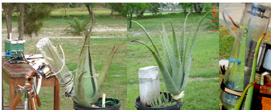
Figura 1. Cámara adaptada para determinar intercambio de gases en hoja de Aloe vera
