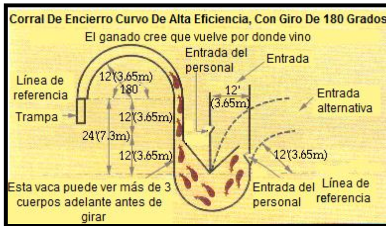
Figura 3: Corral de encierro curvo de alta eficiencia, con giro de 180°
