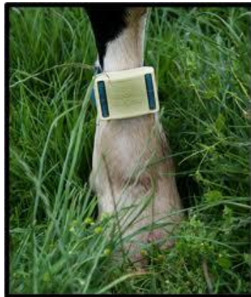
Figura 7. Podómetro instalado en una de las patas de la vaca donde registrara cada paso o movimiento de actividad de la vaca para después descargarlo en la antena de piso instalada en la sala de ordeño.
