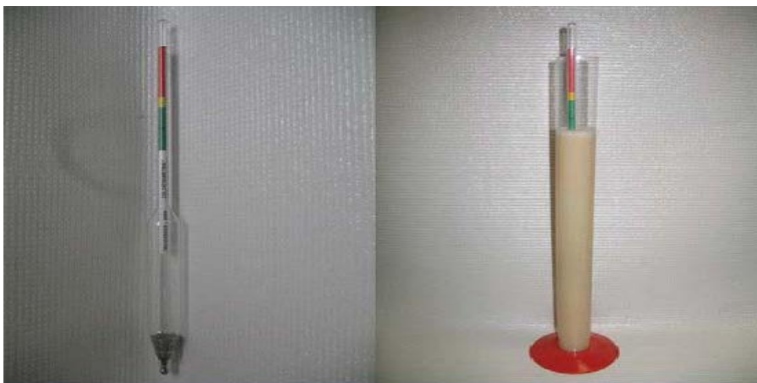
Figura1. Calostrómetro utilizado para medir la concentración de inmunoglobulinas en el calostro. www.calostrometer.com/document/ECAG_importancia_del_calostro.pdf
