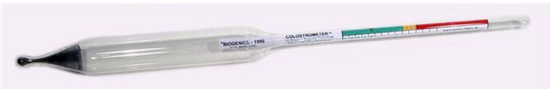
Figura 10.-Calostrometro para medir la densidad y evaluar el calostro.
