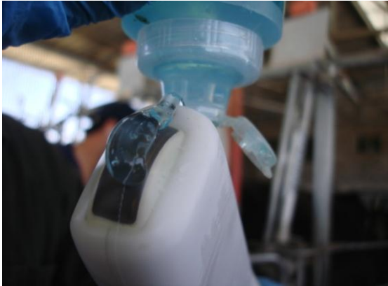
Foto 27 gel para lubricar la punta de la pistola de aspiración.
