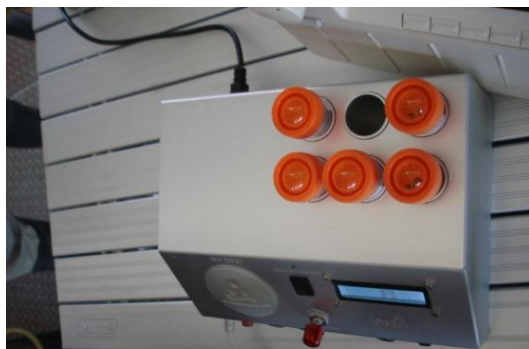
Foto 20 Bomba de vacío encendida y los tubos colectores.
