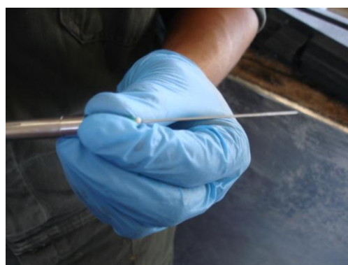
Ilustración 17 aguja de aspiración perfectamente colocada en la varilla de aspiración.
