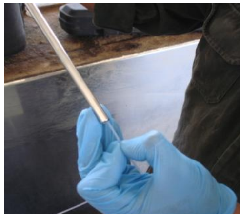
Ilustración 13 Guía de aspiración pasando por la varilla de aspiración.
