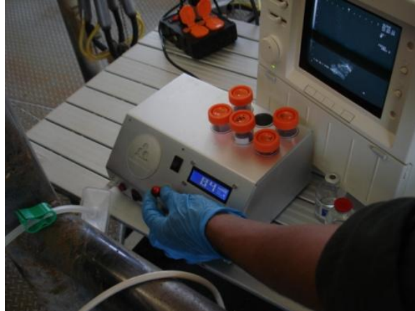
Foto 21 Ajuste de la presión de la bomba de vacío.
