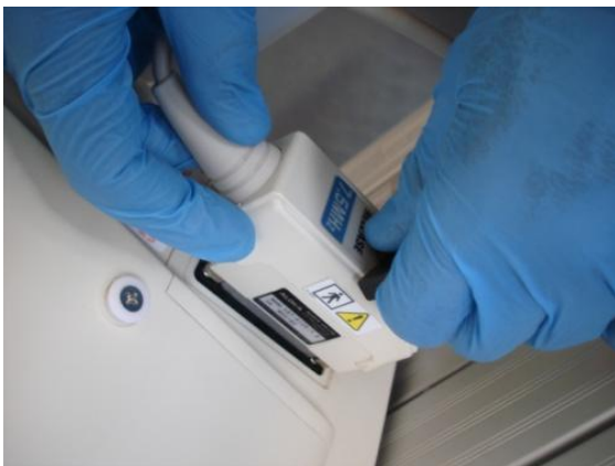
Foto9 Conexión del transductor.
