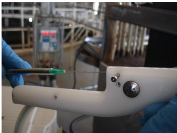
Foto 18 Varilla dentro de la pistola de aspiración.
