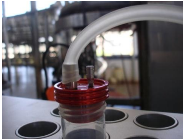
Foto 11 Manguera de vacío conectada con el tapón de vacío.
