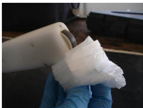
Foto 25 Colocación de la camisa en la pistola de aspiración.
