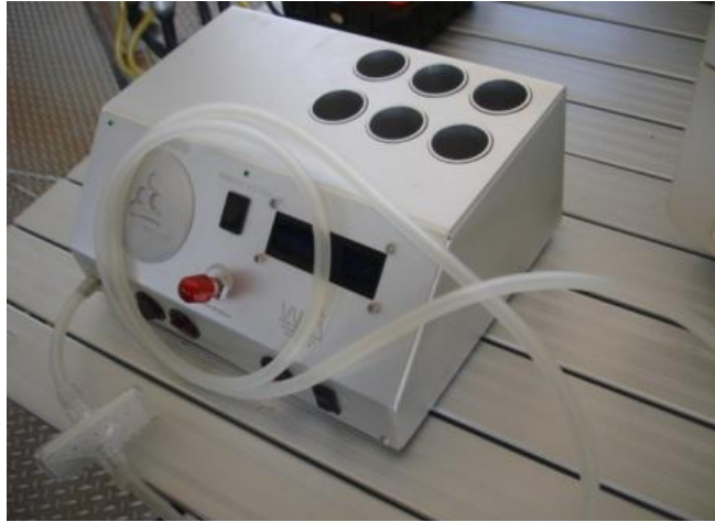
Foto 8 Manguera de vacío conectada a la bomba de vacío.
