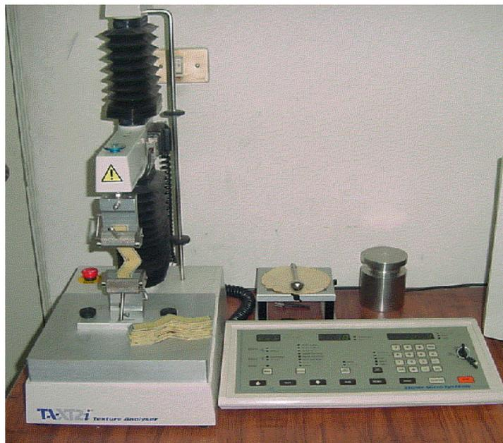
**Fig.2 prueba de rasgado de la tortilla**
