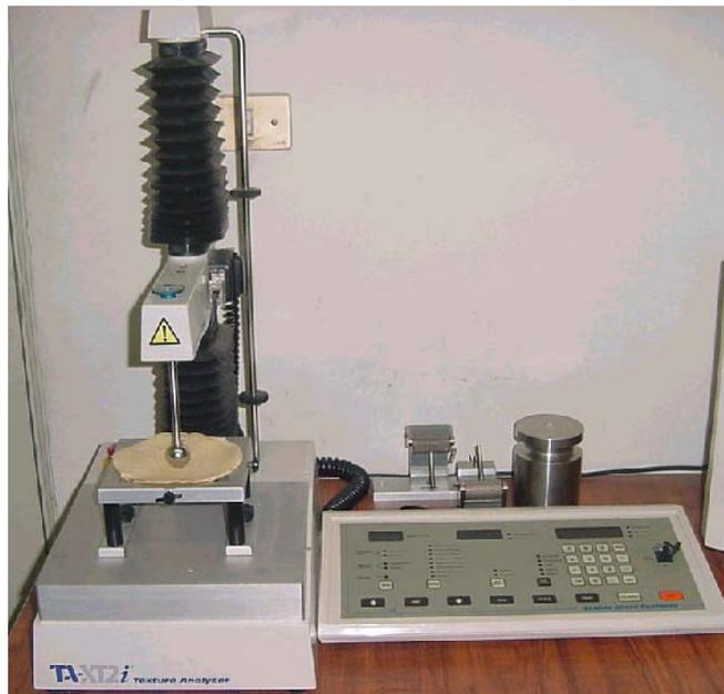
**Fig.3 prueba de punción de la tortilla**
