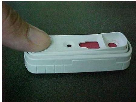
**Figura 9. Dispositivo Snap presionado para su activación.**
