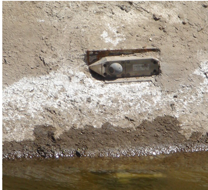
Figura 7. Aforador de tiempo y tránsito (ATT)
