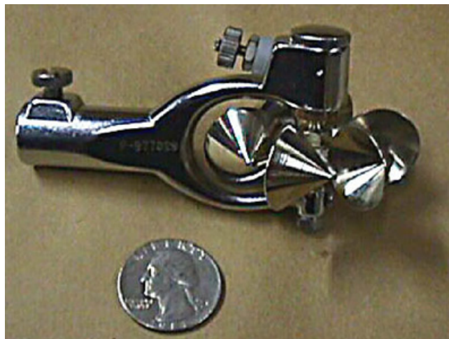
Figura 4. Molinete electromecánico de copas tipo “Pigmeo o enano”.
