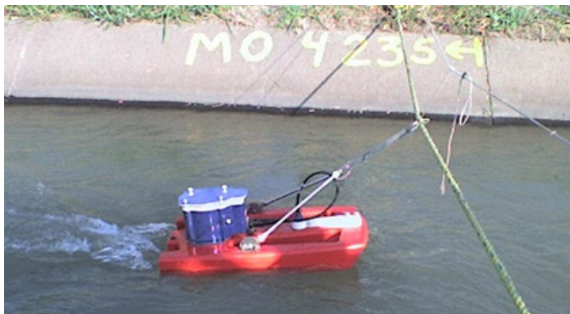
Figura 9. Aforador ultrasónico de efecto doppler vertical “barquito”
