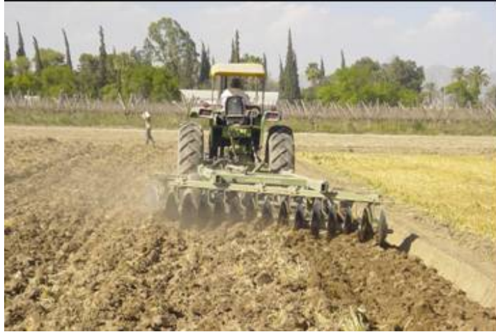
Figura 4. Rastra con dos barras de 14 discos cada una.
