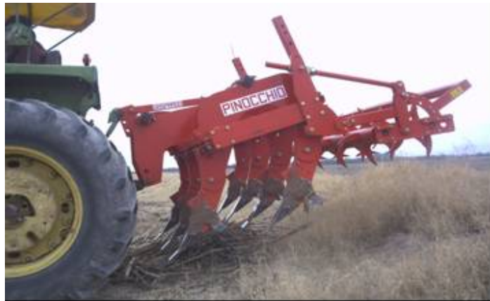
Figura 2. Arado vertical con siete cinceles y rodillos desmenuzadores
