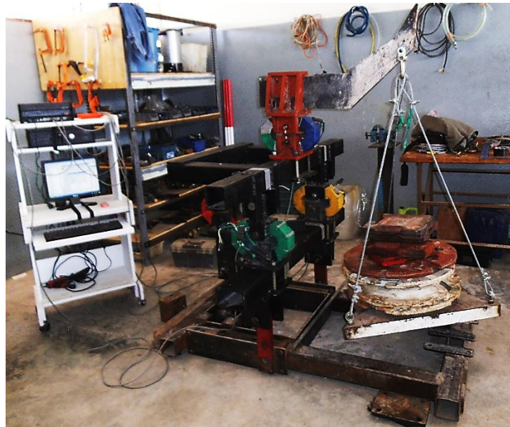
Figura 4.9 Marco de calibración con sensores Octagonal Verde Azul.
