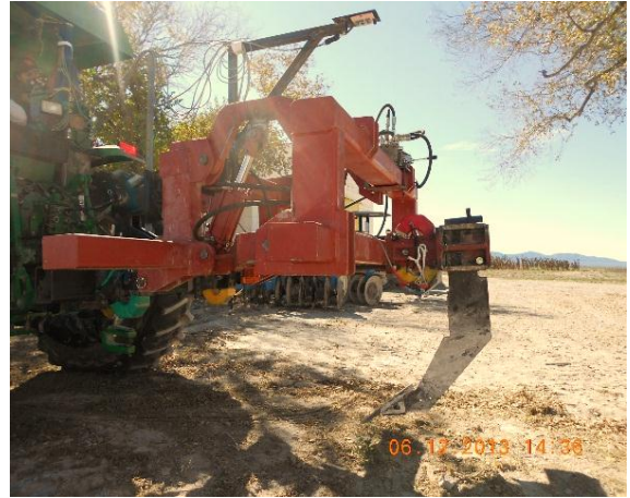
Figura 3.5 Estructura flotante acoplada al sistema transductor integral con el prototipo articulado de cinceles.
