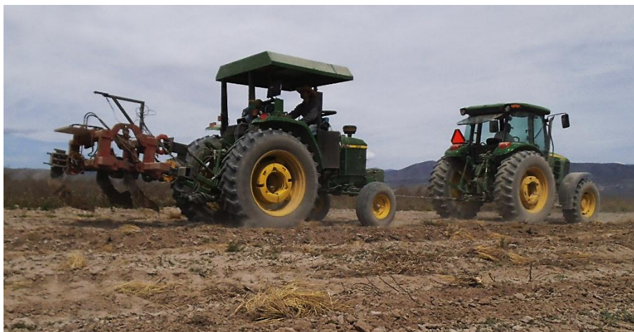
Figura 4.45 Recorrido del tractor con el implemento arriba para determinar la resistencia al rodamiento.
