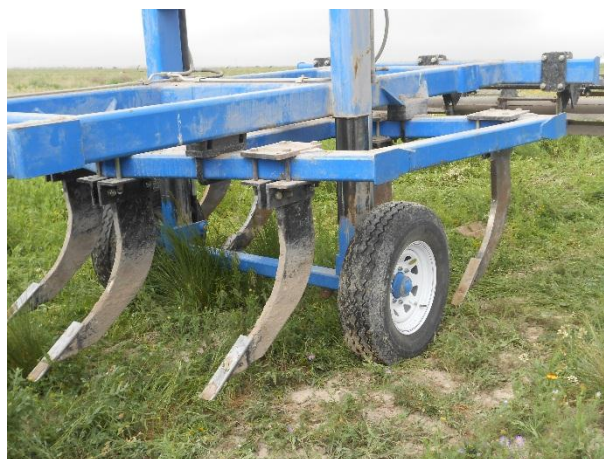
Figura 3.3 Marco del Eco-Byson utilizado para las pruebas de 4 cinceles frontales a 0.20 m de profundidad de labor y para la prueba con 7 cinceles a una profundidad de trabajo de 0.30 m .
