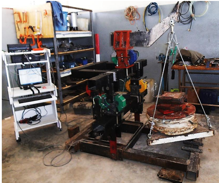
Figura 4.20 Calibración de los transductores (OV), (OA) Y (OR) junto con el octagonal Verde Azul.
