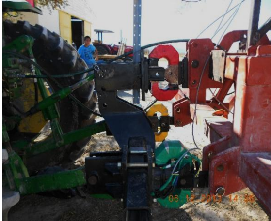
Figura 3.5 Estructura flotante acoplada al sistema transductor integral con el prototipo articulado de cinceles.
