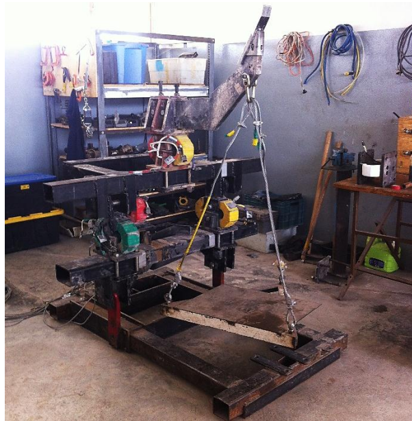
Figura 4.1 Marco de calibración con sensores Octagonal Rojo Amarillo.
