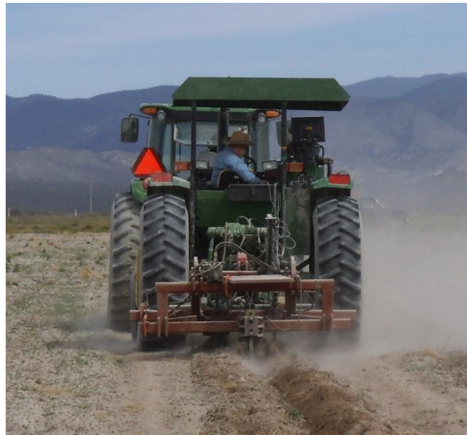
Figura C1 Evaluación con arreglo de tres cinceles (2 frontales a 0.20 m y un trasero sin alas a 0.30 m de profundidad)
