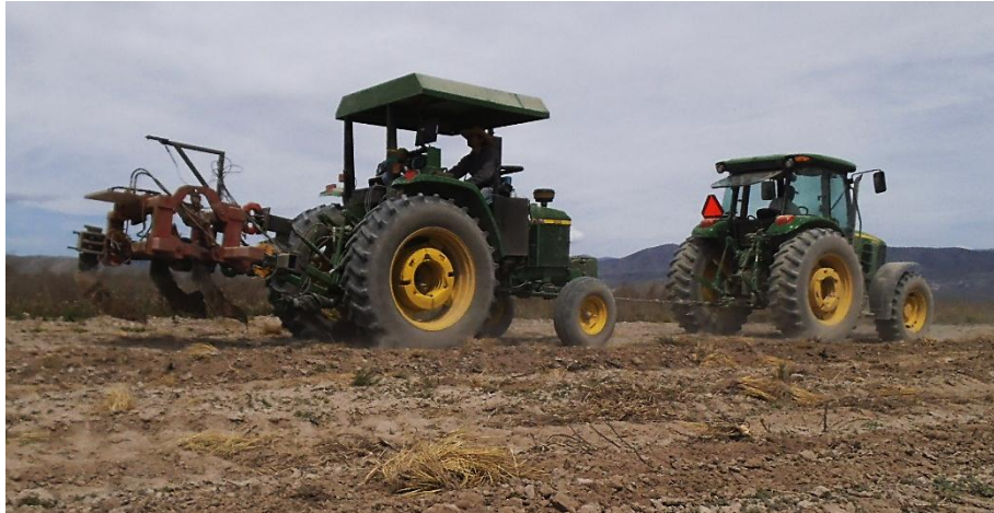
Figura 3.12 Recorrido del tractor con el implemento levantado para determinar la resistencia al rodamiento.
