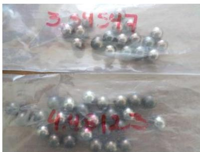
**Figura 9.** Balines utilizados en la prueba de desprendimiento.
