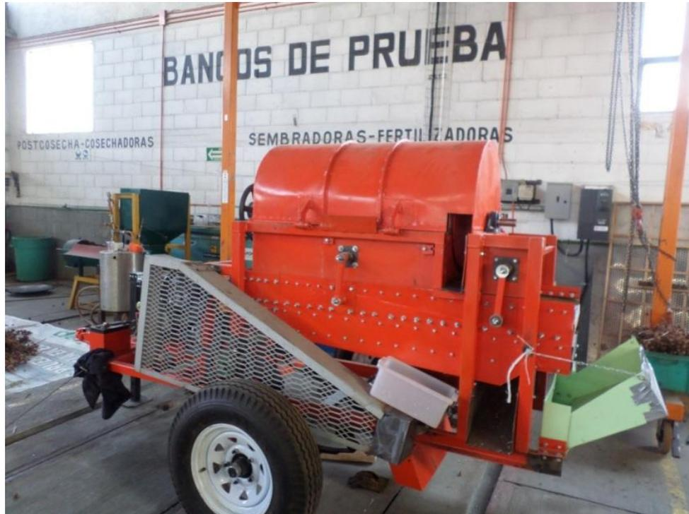
**Figura 3.** Maquina a evaluar con función de trilla y limpieza de Higuierilla.
