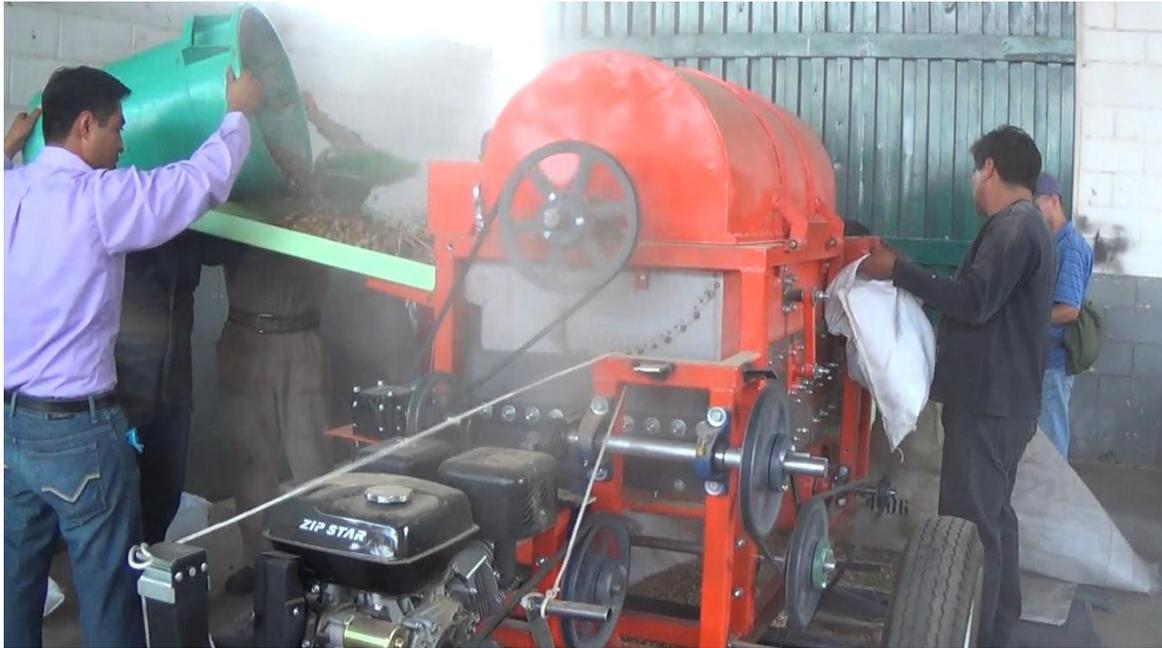
**Figura 7.** Alimentación a la maquina trilladora.
