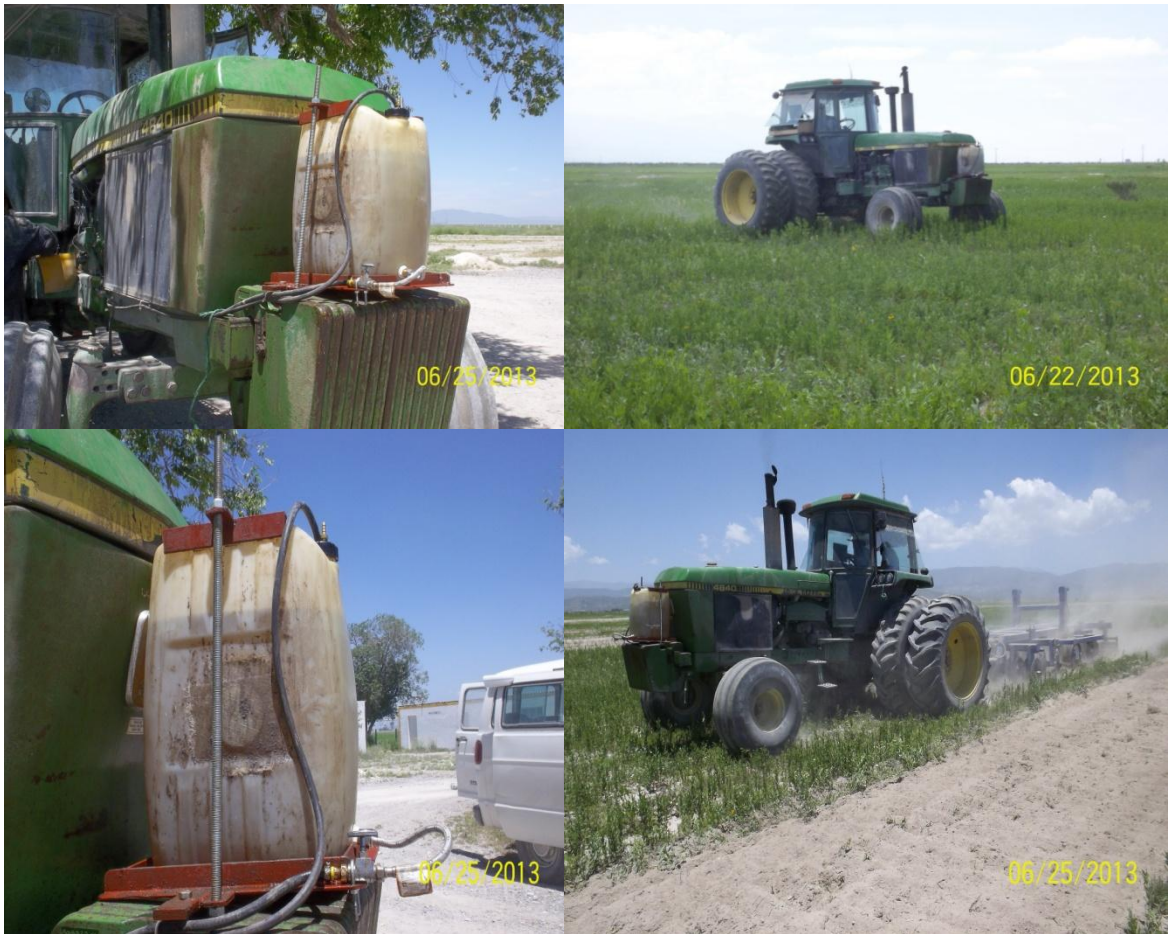
Figura 3.9 Medición de Consumo de Combustible
