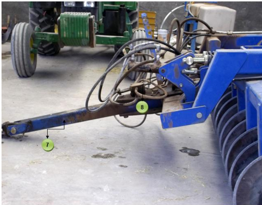
Figura 4.7. Componentes del sistema de levante del Eco-Bison
