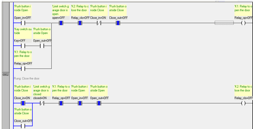
Figura 8.7 Puerta cerrada desde adentro con limit switch activo
