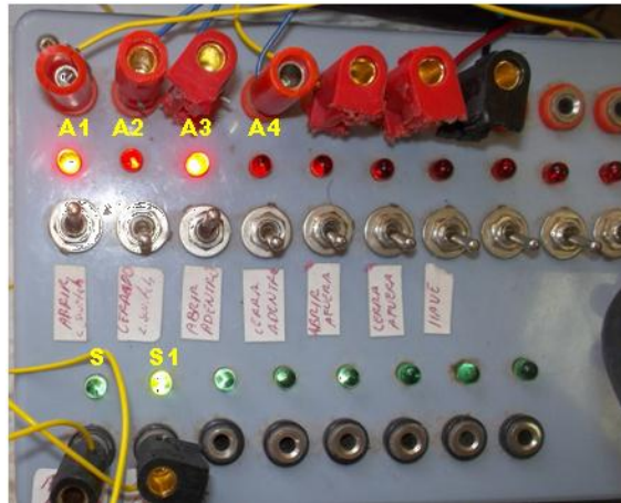
Figura 7.74 Respuesta al segundo caso de las compuertas AND y OR
