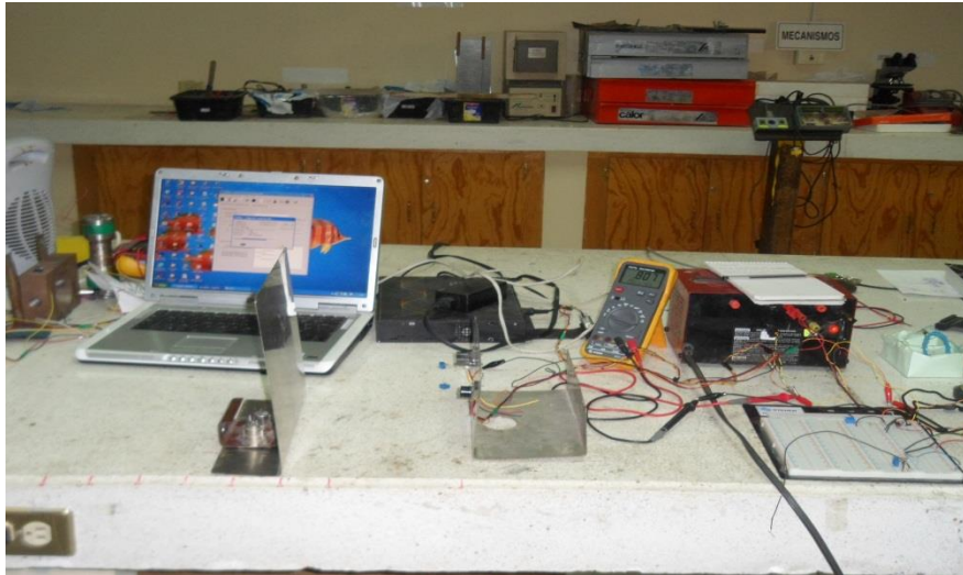
FIG. 4.7 Equipo utilizado para la calibración del sonar
